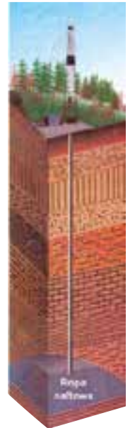
Przekrój szybu naftowego
