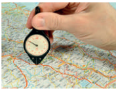
Криві лінії на карті вимірюють за допомогою курвіметра
