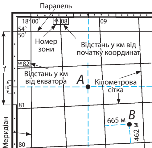
Географічні координати точки А широта – \varphi_A = 54^\circ 49' 15'' ; довгота – \lambda_A = 18^\circ 01' 22'' Прямокутні координати точки В X_B = 6\ 080\ 462 ; Y_B = 4\ 309\ 665
