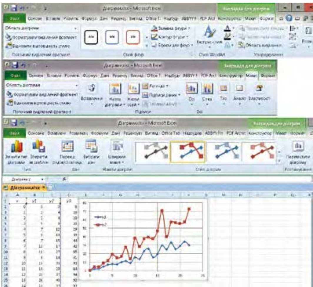
Рис. 7.18. Процедура створення діаграми для Microsoft Excel 2007–2010 (використання стрічкових меню групи Робота з діаграмами )
