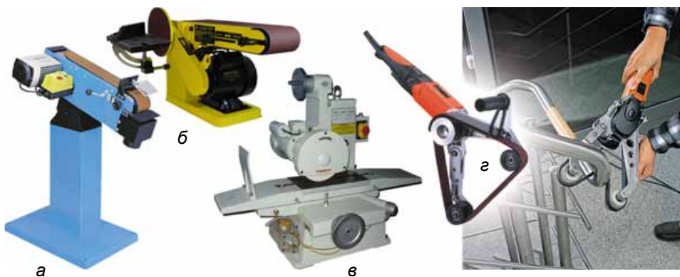
Мал. 130. Шліфувальні верстати: а – стрічково-шліфувальний; б – шліфувально-полірувальний комбінований; в – площинно-шліфувальний; г – шліфування труб
