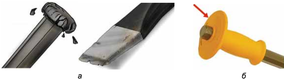
Мал. 72. Різальний інструмент зі збитими деформованими головками, викришеними різальними частинами (а); запобіжна гумова шайба (б)
