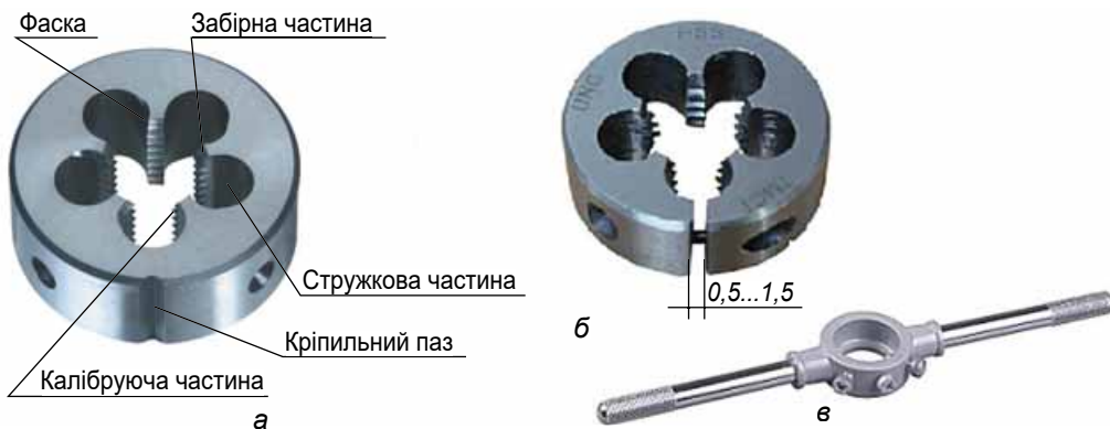
Мал. 114. Інструмент для нарізання зовнішньої різьби: а – плашка суцільна; б – плашка розрізна; в – плашкотримач
