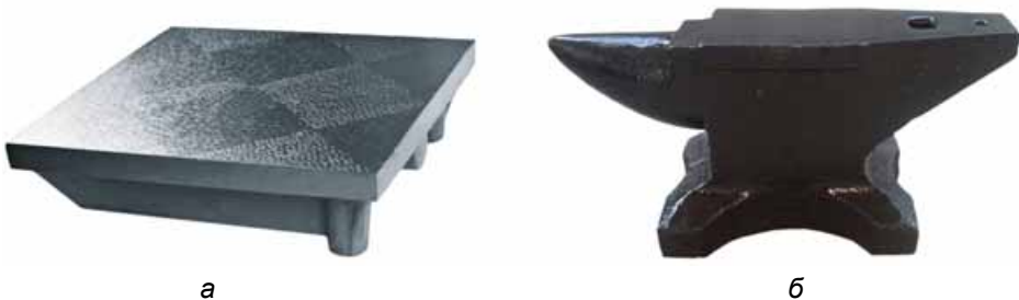
Мал. 64. Пристосування для рубання металу: а – плита; б – ковадло
