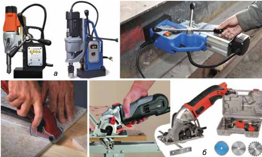
Мал. 131. Свердлильні верстати на магнітній основі (а); роторайзери (б)
