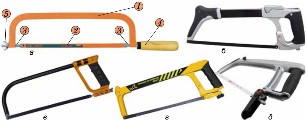
Мал. 50. Слюсарні ножівки: а – суцільна (будова ножівки); б – розсувна; в – з горизонтальним натягом полотна; г – з вертикальним натягом полотна; д – з бічним натягом полотна
