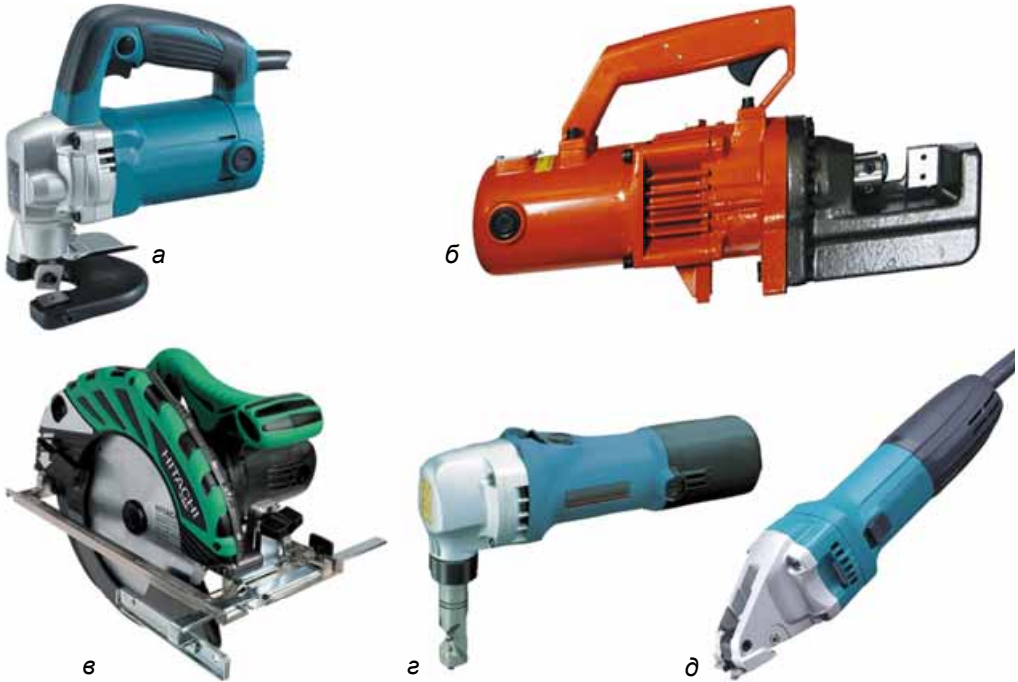
Мал. 122. Електричні різальні інструменти: а – ножиці листові електромеханічні; б – електричний арматуроріз; в – дискова електропилка; г – ножиці висічні; д – ножиці шліцові
