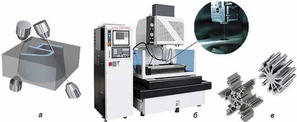
Мал. 135. Електроерозійна обробка: а – схема; б – електроерозійний вирізний верстат; в – продукт електроерозійної обробки
