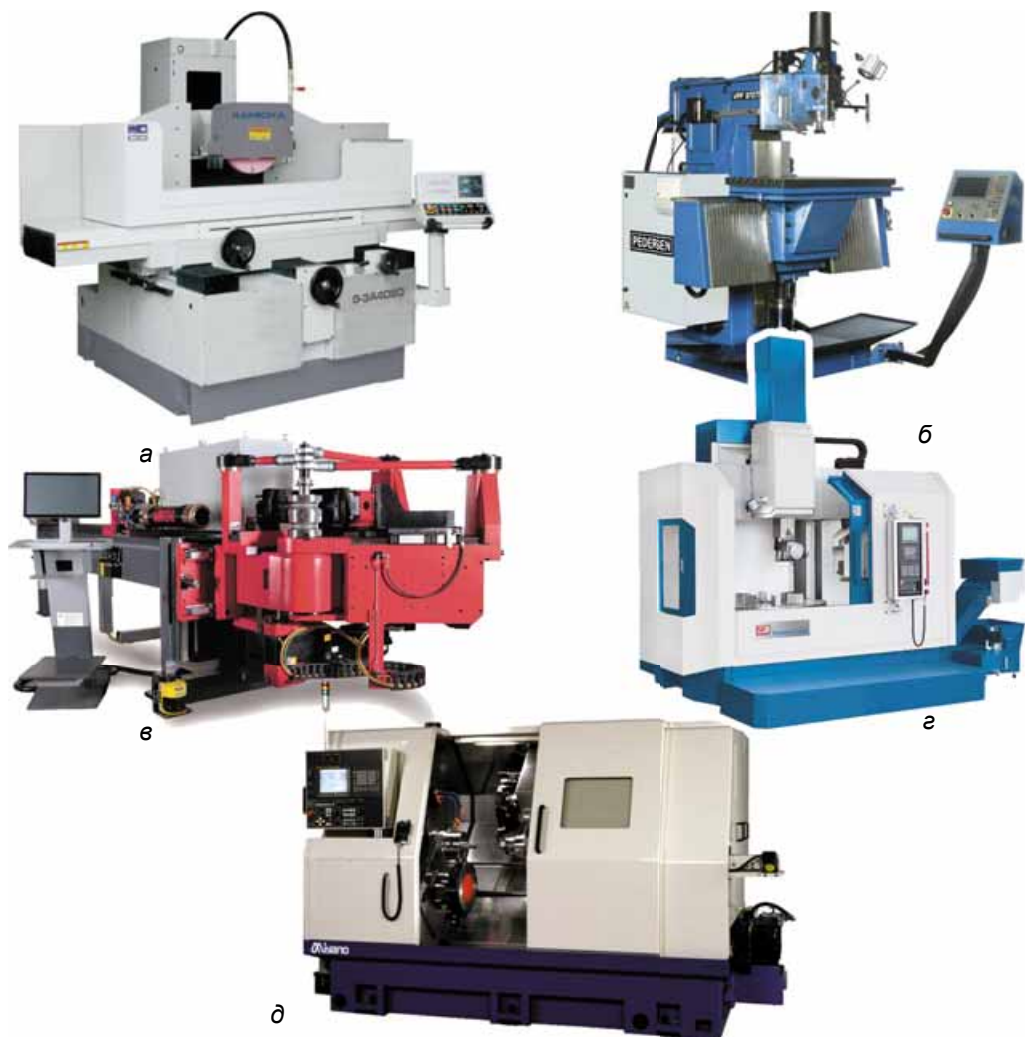
Мал. 132. Металообробні верстати із ЧПК: а – плоскошліфувальний; б – фрезерний; в – трубогінальний; г – вертикально-токарний; д – багатоосьовий обробний центр
