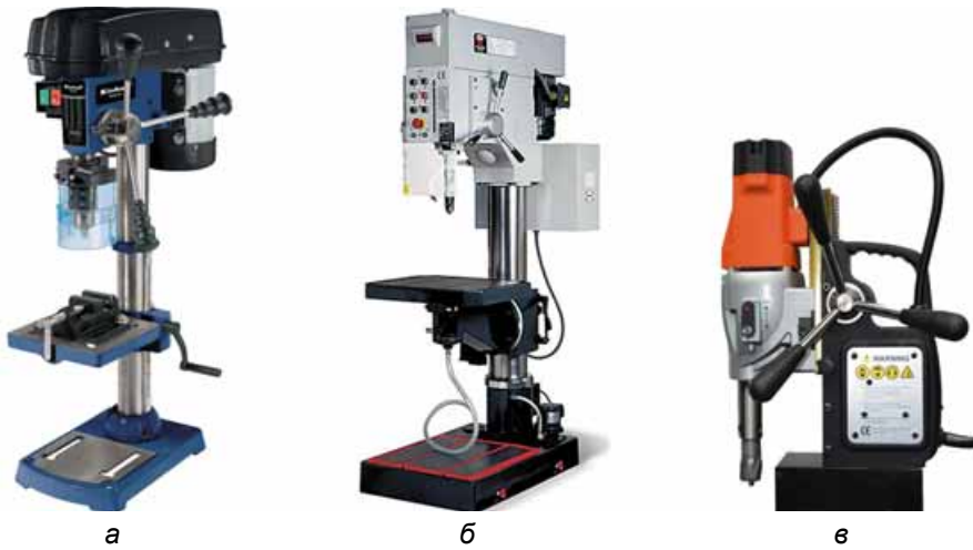
Мал. 127. Свердлильні верстати: а – побутовий свердлильний верстат; б – свердлильний верстат із ЧПК; в – свердлильний верстат на магнітній основі
