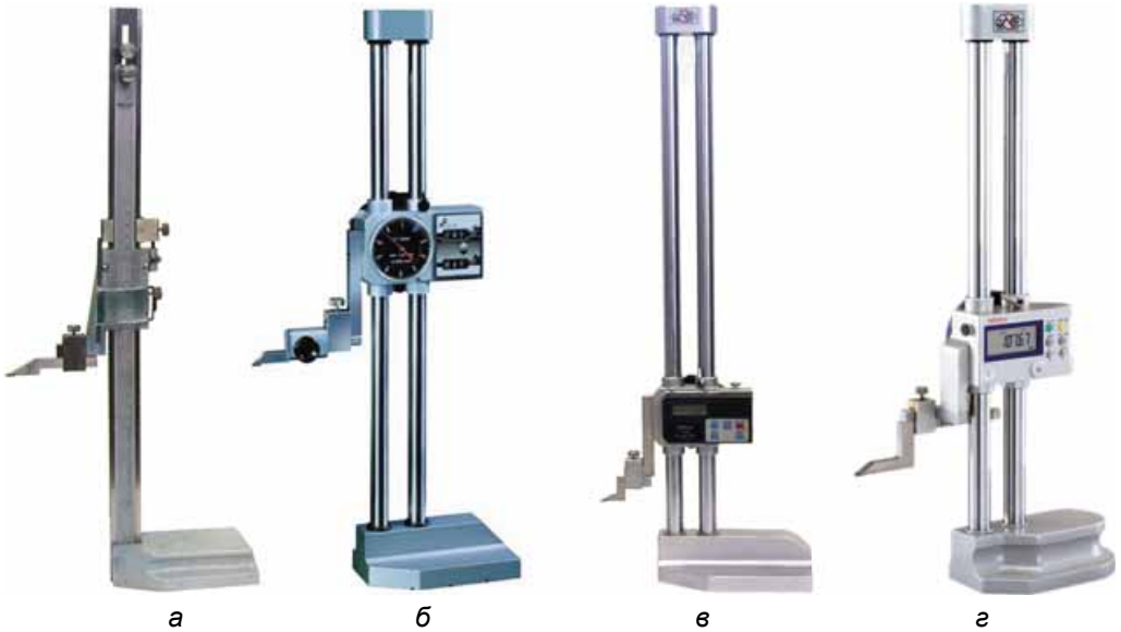
Мал. 44. Штангенрейсмуси: а – механічний; б – вертикальний з індикатором годинникового типу; в, г – вертикальні з електронним індикатором
