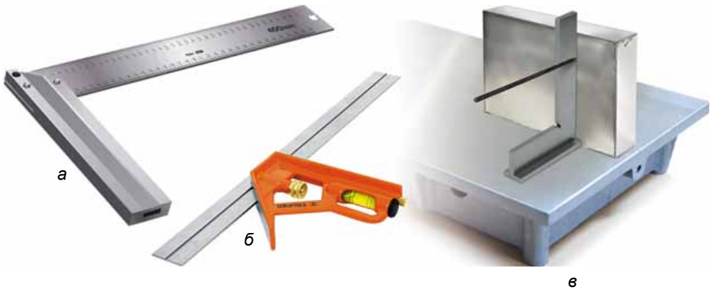
Мал. 45. Розмічання кутником: а – слюсарний кутник з колодкою; б – універсальний кутник з пересувною колодкою; в – спосіб розмічання
