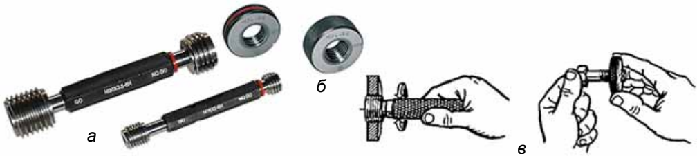
Мал. 109. Контроль якості різьби: а – калібр-пробки; б – калібр-кільця; в – спосіб перевірки
