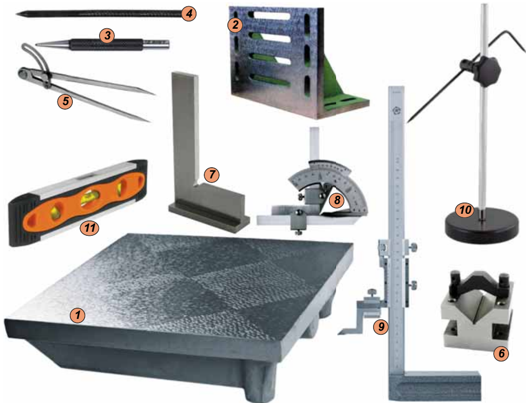
Мал. 41. Інструменти і пристосування, що застосовують для просторового розмічання: 1 – розмічальна плита; 2 – розмічальний ящик; 3 – кернер; 4 – рисувалка; 5 – циркуль; 6 – призма для закріплення циліндричних деталей; 7 – кутник; 8 – кутомір; 9 – штангенрейсмус; 10 – рейсмус; 11 – рівень
