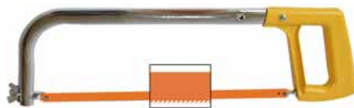
Мал. 53. Кріплення полотна слюсарної ножівки
