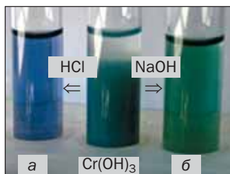
Рис. 62. Результаты взаимо- действия хром(III) гидроксида: а — с кислотой; б — с раство- ром щелочи
