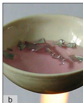
Fig. 26. Acțiunea magneziului asupra apei (adăugarea indicatorului — fenolftaleina): a — rece; b — fierbinte
