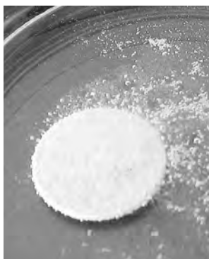
Fig. 58. Reacția unei monede de aluminiu (de 2 cop. bătută în anul 1992) cu acidul clorhidric
