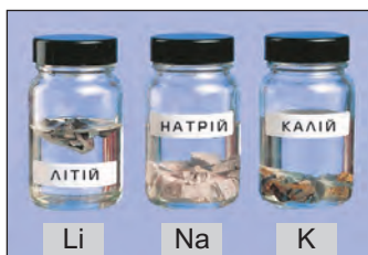
Fig. 3. În acest fel se păstrează metalele alcaline
