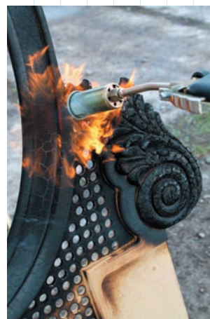
Рис. 83. Обпалювання дерев'яного каркасу меблів
