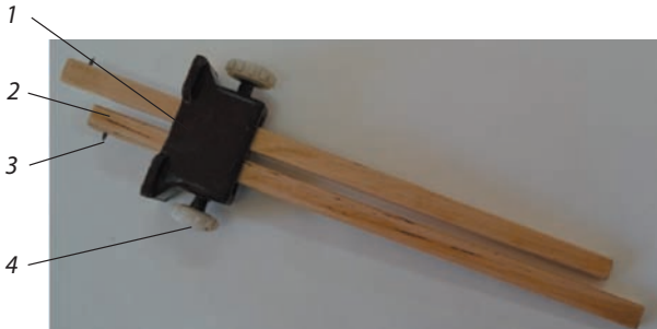
Рис. 41. Будова рейсмуса: 1 – колодка; 2 – бруски; 3 – шпильки; 4 – затискні гвинти (або клин)
