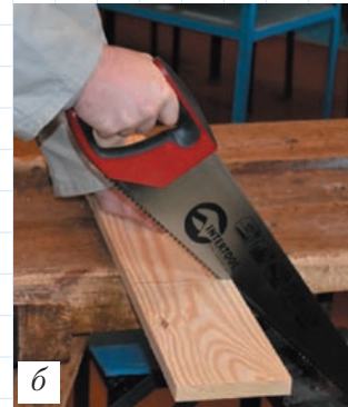
Рис. 49. Нахил ножівки: а – під час пиляння фанери; б – під час пиляння деревини
