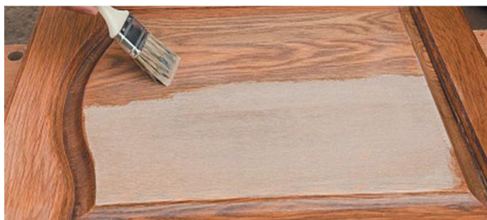
Рис. 76. Під час лакування з'являється малюнок текстури деревини
