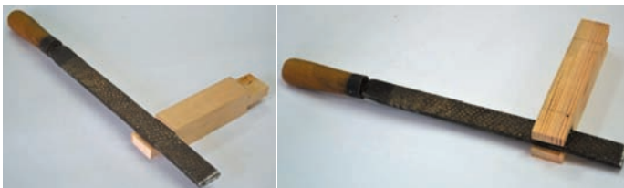
Рис. 72. Припасування вухка (гнізда) рашпілем
