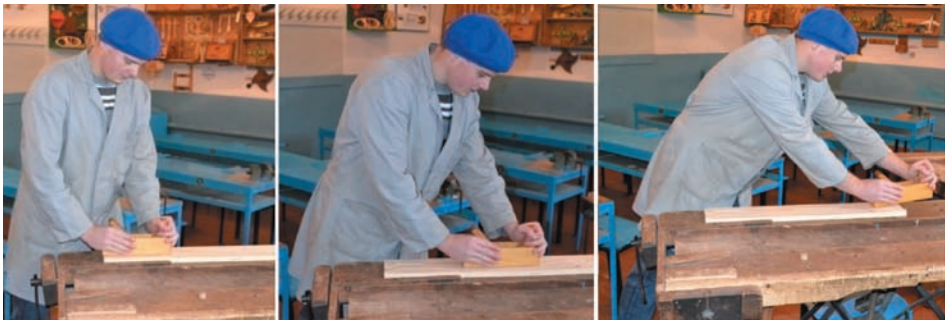
Рис. 58. Стругання: а – крайки (канта); б – пласті
