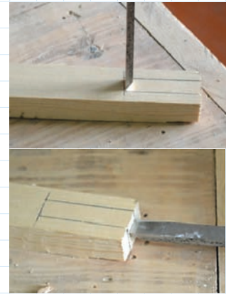
Рис. 71. Виготовлення вухка (гнізда)
