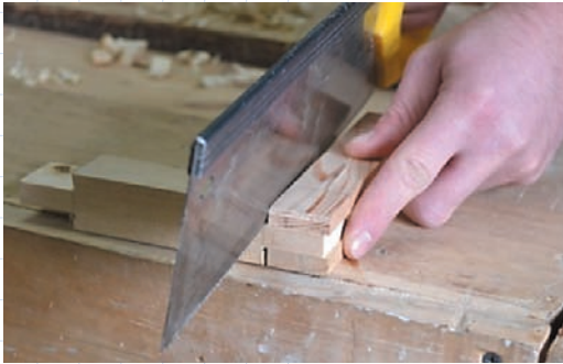
Рис. 73. Припасування шипового з'єднання ножівкою
