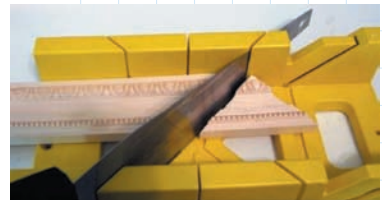
Рис. 50. Стусло: а – види стусел; б – пиляння за допомогою стусла
