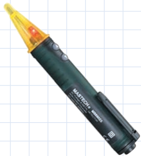
Рис. 113. Детектор Mastech. Цей прилад визначає не тільки електричний дріт, а й металеву арматуру, що також може стати перешкодою для свердління
