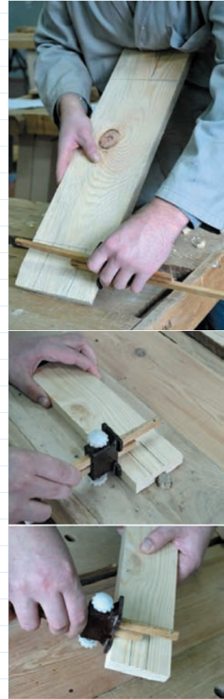
Рис. 66. Прийоми розмічання шипового з'єднання рейсмусом
