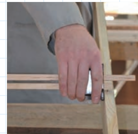
Рис. 43. Розмічання рейсмусом для стругання пласті
