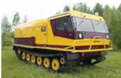
Мал. 149. Для зменшення тиску колеса транспортних засобів роблять ширшими
