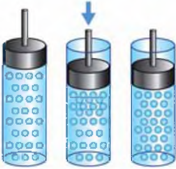
Мал. 157. При зменшенні об'єму заданої маси газу — тиск збільшується
