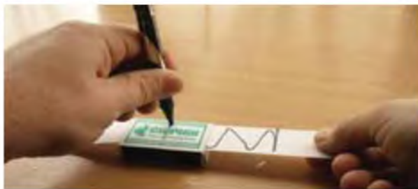
Мал. 40. Дослід, що ілюструє відносність траєкторії: а — пристрій для побудови траєкторії; б — вигляд траєкторії на нерухомій і рухомій стрічці
