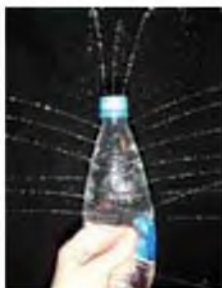
Мал. 167. Саморобний прилад для демонстрації закону Паскаля
