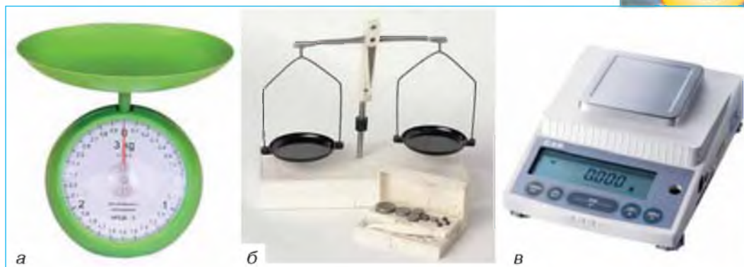
Мал. 7. Прилади для вимірювання маси: а — пружинні настільні ваги; б — шкільні важільні терези; в — електронні ваги
