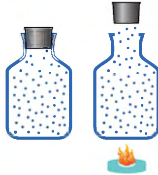
Мал. 158. Тиск газу в закритій посудині буде тим більший, чим вища температура газу, за умови, що маса газу не змінюється
