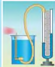
Мал. 194. Вимірювання тиску рідини на різних глибинах
