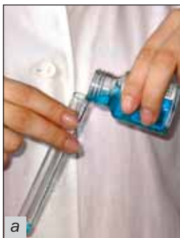
Мал. 17. Переливання рідини: а — із банки в пробірку; б — за допомогою скляної палички; в — із однієї пробірки в іншу
