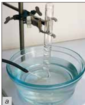
Мал. 56. Збирання кисню: а — витисненням води; б — витисненням повітря
