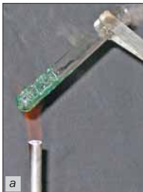
Мал. 20. Нагрівання рідини у пробірці: а — закріплений у пробірکو- тримачі; б — закріплений у штативі
