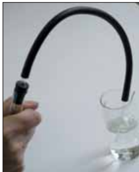
Мал. 59. Перевірка приладу на герметичність
