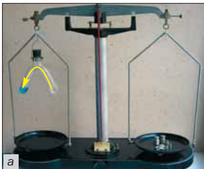
Мал. 52. Дослід із підтвердження закону Ломоносова — Лавуазьє: а — початок досліду; б — завершення досліду
