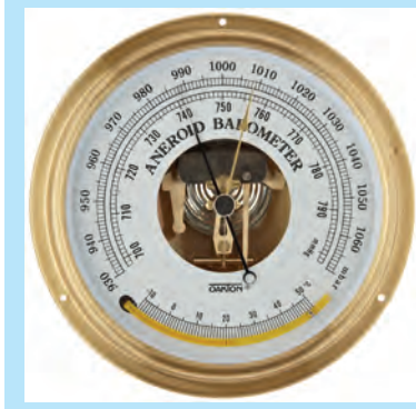
Рис. 26.8. Барометр-анероид. Принцип действия
