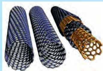
Рис. 37.3. Углеродные нанотрубки намного легче и крепче стали
