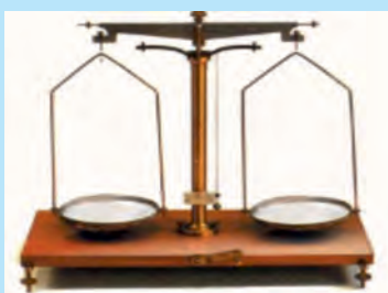
Рис. 19.2. Массу тела определяют с помощью рычажных весов
