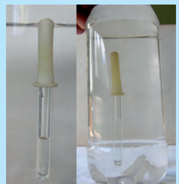
Рис. 29.3. «Картезианский водолаз», сделанный из пипетки и пластиковой бутылки
