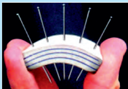
Рис. 20.9. Деформация изгиба показывает, что внутренняя часть ластика не деформируется
