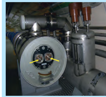
Рис. 37.9. Система охлаждения и две трубки, по которым двигаются протоны
