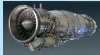
Рис. 15.4. Вал турбины реактивного двигателя делает 30 000 оборотов в минуту
