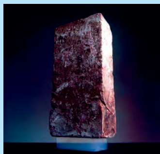
Рис. 37.4. Аэрогель имеет плотность воздуха и прочность кирпича
