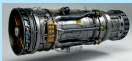
Рис. 37.8. Турбореактивный двигатель современного самолета содержит около 6000 высокотехнологических деталей
