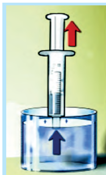
Рис. 27.4. Вода двигается за поршнем насоса, потому что ее туда «втискивает» сила атмосферного давления
