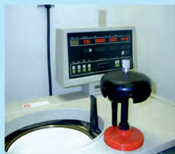
Рис. 22.8. Вес тела в ультрацентрифуге может превышать нормальный в 70 000 раз
