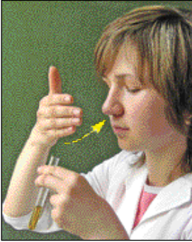
15. ábra. Ismeretlen anyag szagának megállapítása
