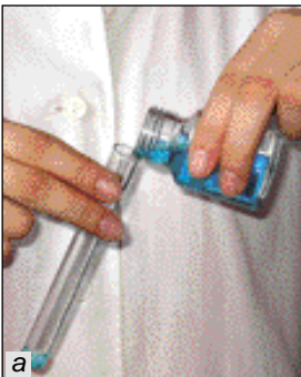
17. ábra. Folyadék áttöltése: a – üvegedényből kémcsőbe; b – üvegpálcika segítségével; c – egyik kémcsőből a másikba
