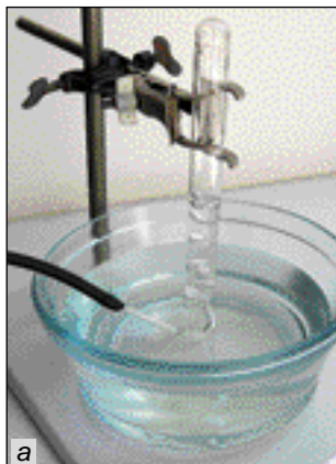
56. ábra. Oxigéngyűjtés: a – vízkiszorítással; b – levegőkiszorítással
