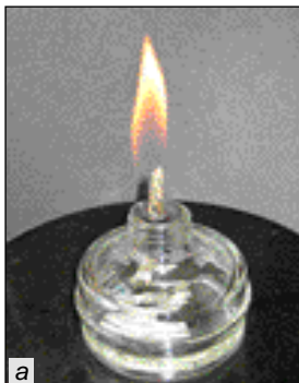
13. ábra. Melegítésre szolgáló készülékek: a – szeszégő; b – láng oltása kupakkal; c – gázégő
