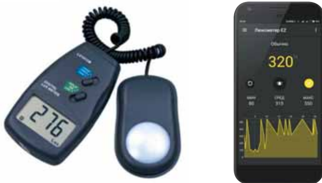
Мал. 28.6. Досліджуй освітленість: а — люксометр, б — електронний застосунок
