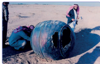
Мал. 172. Моторний кожух двигуна 3-го ступеня РН «Delta» вагою близько 70 кг упав за 240 км від м. Ер-Ріяд (Саудівська Аравія, 2001 р.)
