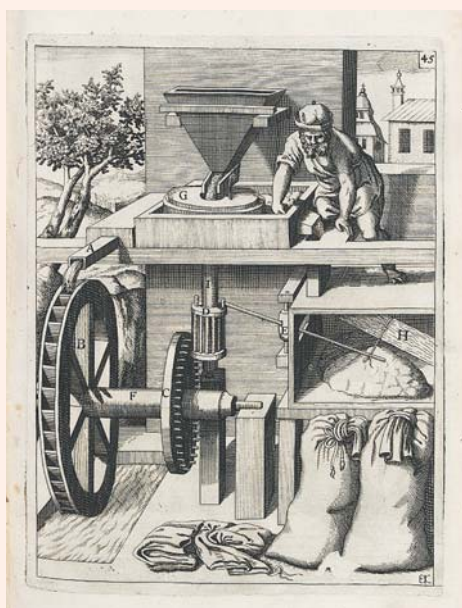
Схема водяного млина з питлем. Гравюра з книжки Г. А. Беклера Theatrum Machinarum Novum (1661)
