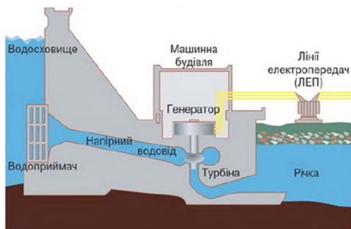
Мал. 128. Схема греблі гідроелектростанції
