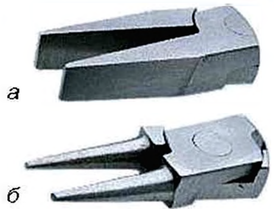
Мал. 134. Форма робочої частини плоскогубців (а) і круглогубців (б) у збільшеному вигляді
