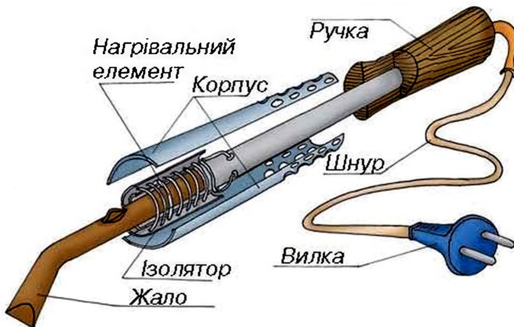
Мал. 104. Зовнішній вигляд та будова електропаяльника
