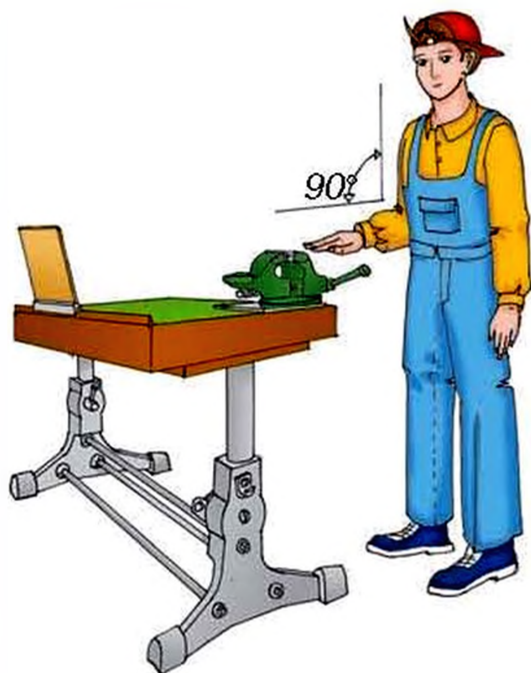
Мал. 11. Перевірка правильності вибору висоти слюсарного верстака
