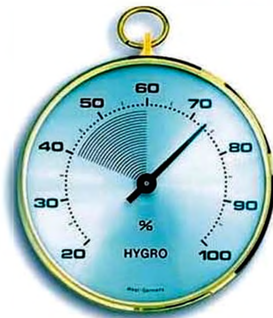
Мал. 217. Гігrometer дозволяє визначити рівень вологості повітря
