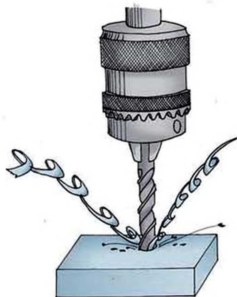
Мал. 175. Формування зливної (суцільної) стружки
