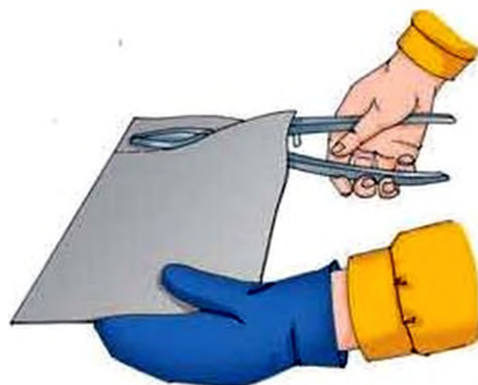
Мал. 74. Хватка ножиць при різанні тонколистового металу
