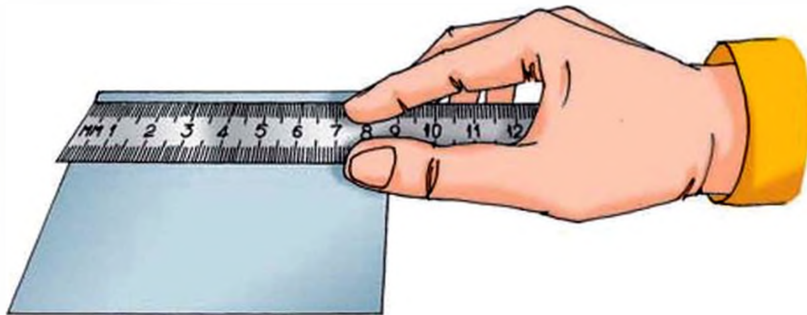
Мал. 63. Визначення розміру деталі за допомогою масштабної лінійки
