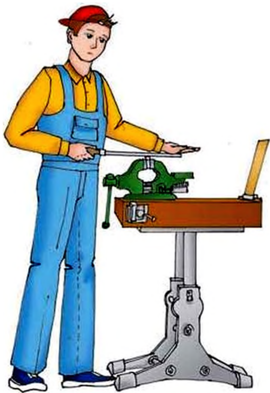
Мал. 83. Положення корпусу під час обпилювання деталі
