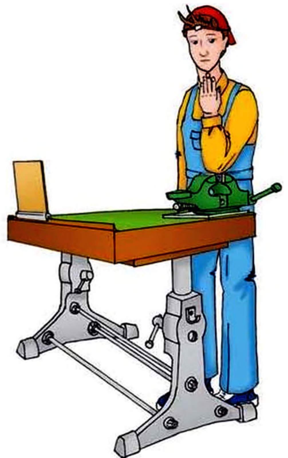
Мал. 9. Перевірка правильності регулювання висоти робочого місця під час виконання слюсарних робіт
