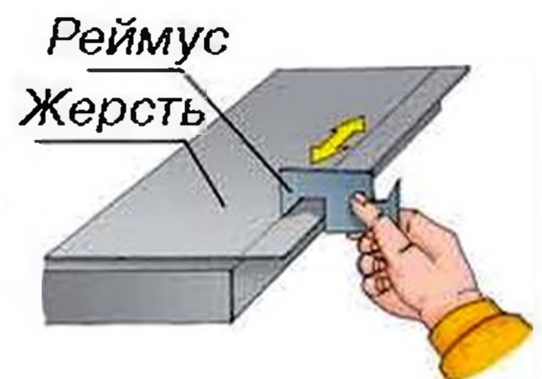
Мал. 118. Розмічання відгинів фальцювання рейсмусом
