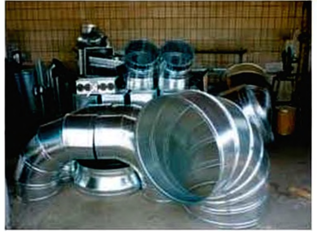
Мал. 101. Елементи промислової вентиляції з використанням фальцьових швів
