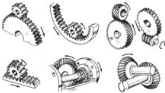
Мал. 231. Різновиди зубчастої передачі
