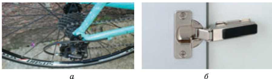
Мал. 238. Приклади рухомих з'єднань: а — у велосипеді; б — у навісних петлях для відкриття та закриття дверей
