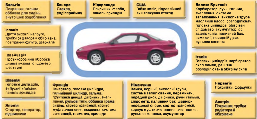
Мал. 1. Кооперування зв'язків виробництва авто Ford Escort
