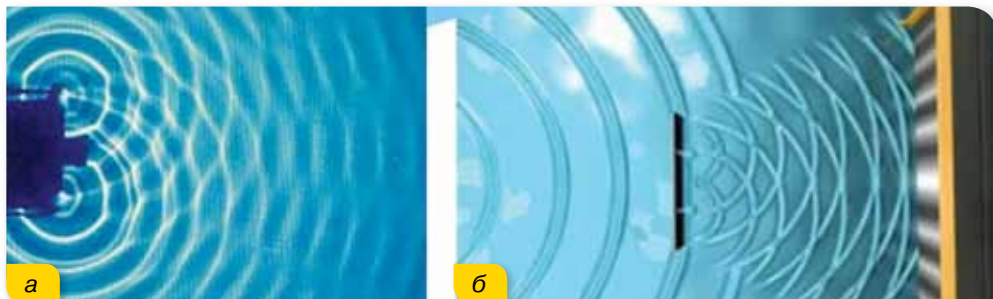
Мал. 108. Утворення інтерференційної картини: а — від двох когерентних джерел; б — від двох щілин (після проходження щілин також утворюються когерентні хвилі)
