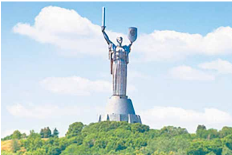
Рис. 25.5. Обшивку статуї «Батьківщина-мати» (Київ, Національний музей історії України в Другій світовій війні) створено в Запоріжжі з неіржавної сталі. З окремих блоків-секцій масою 25–30 тонн кожна скульптуру було зварено на Київському заводі імені Паризької комуні з урахуванням рекомендацій Інституту електрозварювання імені Є.О. Патона. Статую ліплює з образу борзнянки 1 , скульпторки Галини Никифоровни Кальченко
