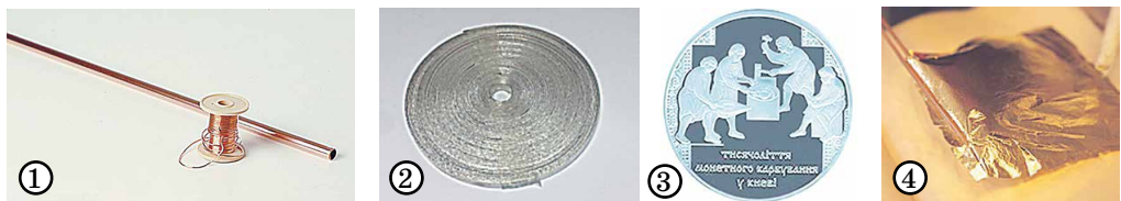
Рис. 23.5. Метали здебільшого пластичні. 1. Дріт і трубка виготовлені з міді. 2. Магнієва стрічка. 3. Срібна (Ag 925) ювілейна монета «Тисячоліття монетного карбування в Києві» присвячена першому карбуванню монет Київської Русі – златників і срібляників – наприкінці X – на початку XI ст. – за часів князя київського Володимира Великого. 4. Золота фольга 0,00001 мм завтовшки
