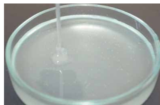
Рис. 21.1. 1. Пропускання карбон(IV) оксиду крізь вапняну воду.
