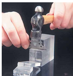
Рис. 8.1. Кристали галіту (кам'яної солі NaCl) мають кубічну форму, їх легко розколоти за гранями куба
