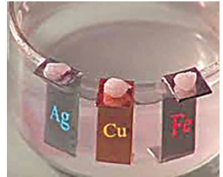
Рис. 23.4. Дослід з порівняння теплопровідності металів
