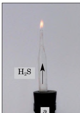
46. ábra Kénhidrogén égése: a – tökéletes égés, elegendő oxigénnel; b – tökéletlen égés, oxigénhi- ány esetén
