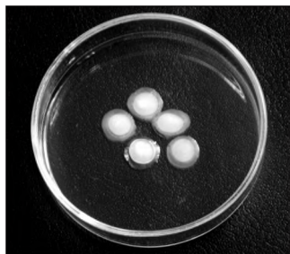
76. ábra A levegő víz- tartalma elnyelésé- nek eredménye nátrium-hidroxid granulátum által
