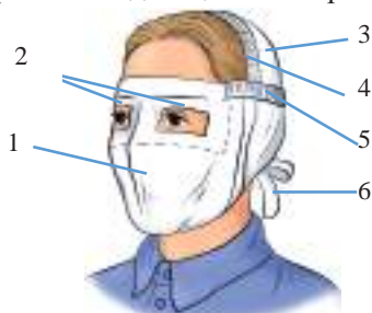
Іл. 27.4. Протипилова тканинна маска ПТМ-1: 1 — корпус маски; 2 — оглядові отвори; 3 — кріплення; 4 — гумова тасьма; 5 — поперечна гумова смужка; 6 — зав'язки
