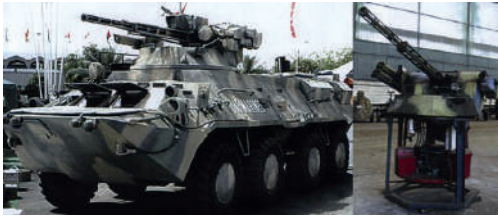
Іл. 32.2 в. Бронетранспортер БТР-3У з бойовим модулем «Шквал»
