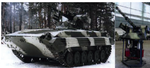
Іл.32.1. БМП-1 (а); БМП-2 з бойовим модулем «Шквал» (б)
