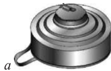
Іл. 47.1. Протитанкова міна ТМ-62М: а — загальний вигляд міни з підривачем МВЧ-62 в транспортному положенні; б — розріз міни без підривача (з пробкою): 1 — корпус; 2 — пробка; 3 — прокладка; 4 — заряд; 5 — дно; 6 — додатковий детонатор; 7 — вушко для кріплення ручки
