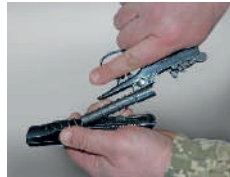
Іл. 35.5. Відокремлення затвора від рамки
