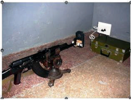
Іл. 33.3. Кріплення автомата на прицільному верстаті ПС-51
