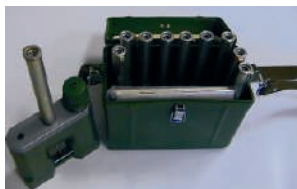
Іл. 70.3. Комплект ІД-1: 1 — індивідуальний дозиметр; 2 — зарядний пристрій
