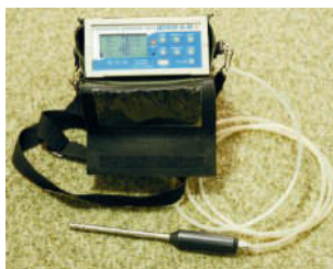
Іл. 71.4 Газосигналізатор «ДОЗОР-С-М-5Н»
