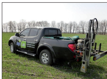
Fig. 94. Analizor chimic de sol pe auto- mobil
