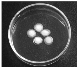
Fig. 76. Rezultatul absorbirii vaporilor de apă de către granulele de hidroxid de sodiu
