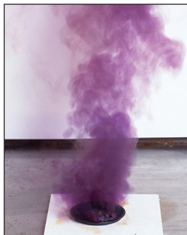
Fig. 64. Reacția dintre aluminiu și iod
