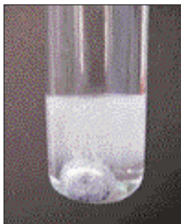
Fig. 65. Reacția dintre alumiuniul și bază în soluție
