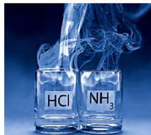
Рис. 17. Утворення амоній хлориду з амоніаку й гідроген хлориду
