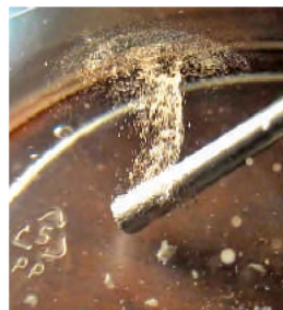
Рис. 46. Взаємодія алюмінію з водою
