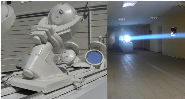
а б Мал. 1.3. Целостатна група (а) та об'єкти горизонтального сонячного телескопа (б) АЦУ-5 ГАО НАН України
