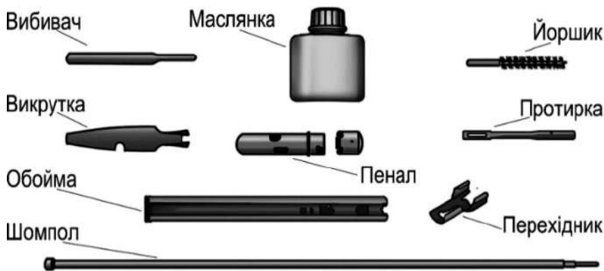
Лл. 18.3. Приладдя для чищення автомата АКС-74 (зберігається в сумці для магазинів)
