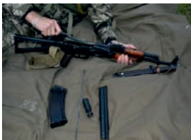
Іл. 19.7. Відокремлення зворотного механізму
