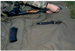
Іл. 19.5. Відокремлення дульного гальма-компенсатора
