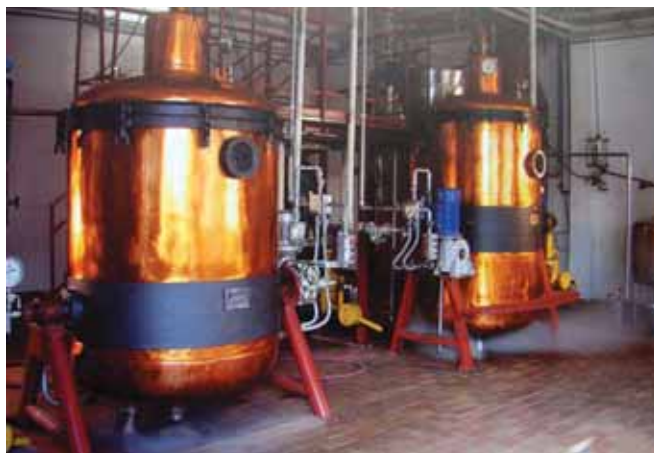
Мал. 91. Сучасні перегонні куби для добування етанолу
