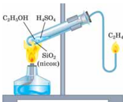
Мал. 36. Прилад для добування етену в лабораторії
