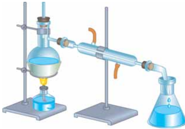
Мал. 71. Перегонка нафти в лабораторії
