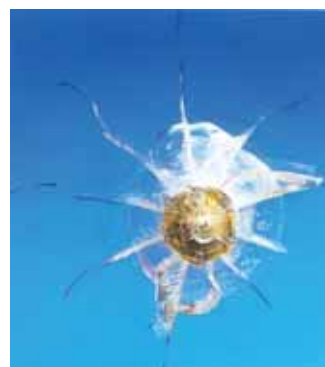
Мал. 159. Куленепробивне скло виготовляють із полімерних матеріалів
