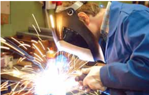
Мал. 48. Для ацетилено-кисневого зварювання металу (а) використовують спеціальне обладнання (б)
