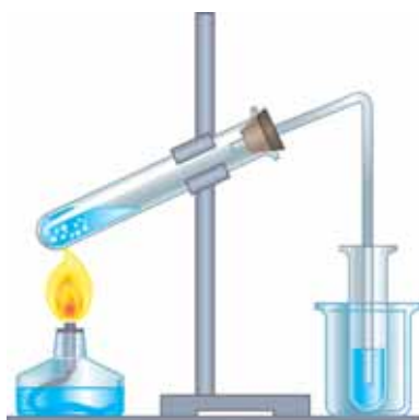
Мал. 168. Прилад для добування етену з етанолу
