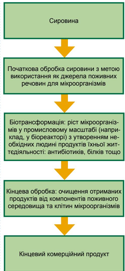
Мал. 317. Основні етапи біотехнологічного процесу: від початкової обробки сировини до отримання очищеного кінцевого продукту
