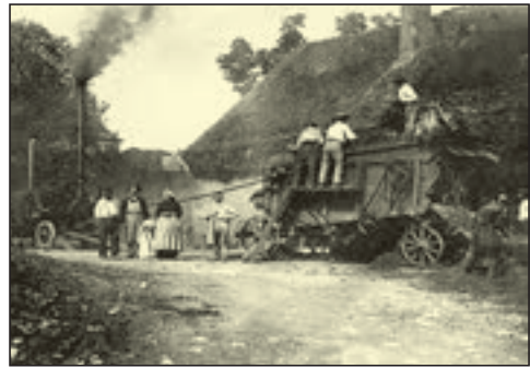
Використання парової машини для молотіння зерна
