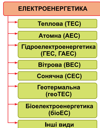
Мал. 88. Склад електроенергетики
