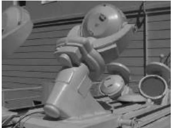
Рис. 5.4. Целостатна група горизонтального сонячного телескопа АЦУ-5 ГАО НАН України
