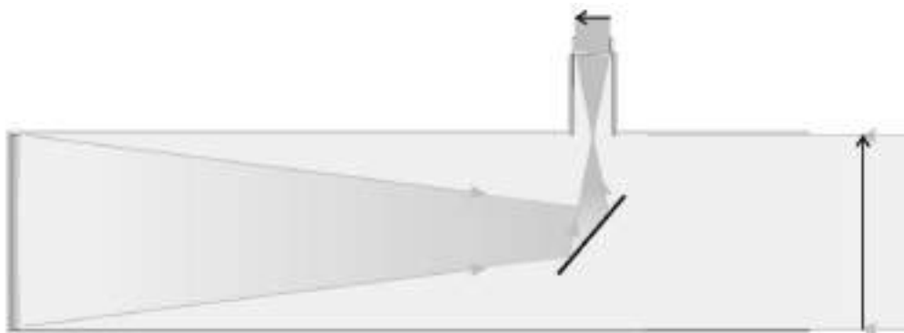
Рис. 5.3. Хід променів (оптична схема) в телескопі-рефлекторі
