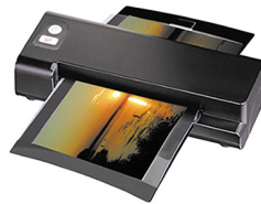
Мал. 2.25. Настільний сканер з протяжним механізмом
