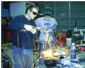
Fig. 67. Tăierea metalului cu ajutorul lămpii cu acetilenă
