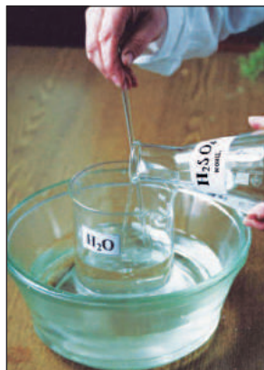
Fig. 9. Prepararea corectă a unei soluții diluate de acid sulfuric
