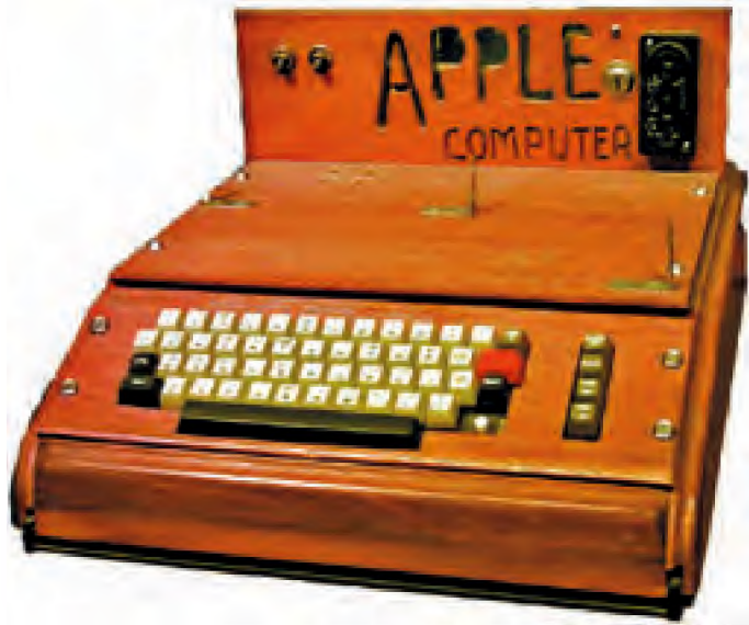
1.9. ábra. Az Apple első személyi számítógépe, amely még tévékészüléket használt megjelenítő eszközként
